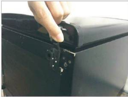
6.Align the bottom hinge.
